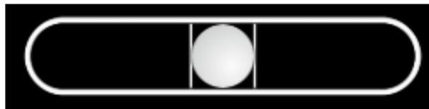
Der Side-Slip-Meter funktioniert entsprechend, aber nun bezogen auf eine seitliche Flugbewegung.
